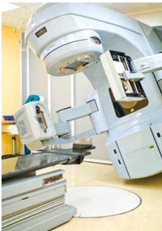
Obr. 5. Lineární urychlovač se zabudovaným systémem cone beam CT
