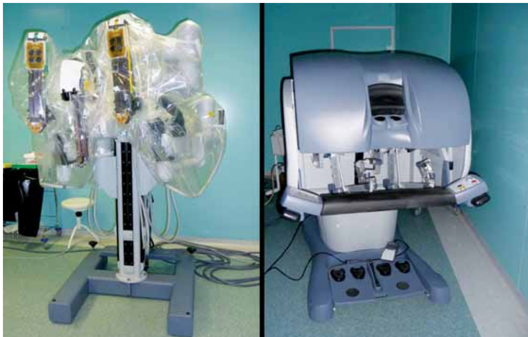
Obr. 1. Robotický systém Da Vinci, 3-ramenný Fig. 1. Three-armed robotic system Da Vinci
