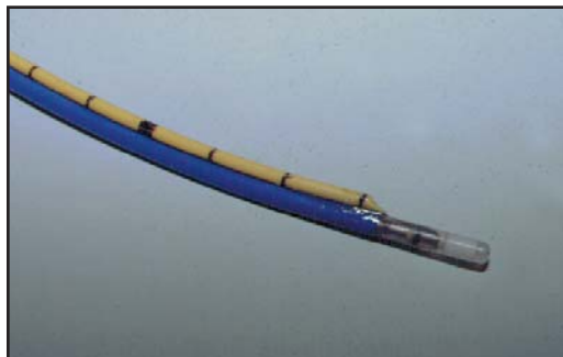
Obr. 5: Experimentální snímač pro synchronní měření profilometrie
