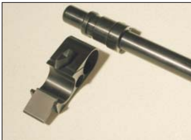
Obr. 1. Elektronicky řízený vytahovač snímače.
